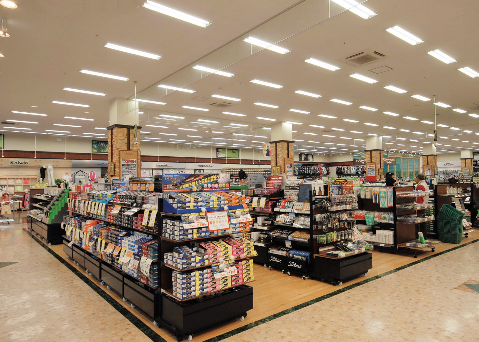
ゴルフ5店内 エントランス側から中央売場を望む。ベース照明はHF32W2灯用下面開放器具をライン配置にして、動線上にはFHT42W3灯用蛍光灯ダウンライトを配している
