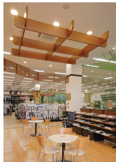
商談コーナー 装飾用吊り天井が特徴的な商談コーナー。FHT42W3灯用ダウンライト(電球色)で落ち着き感を与える
